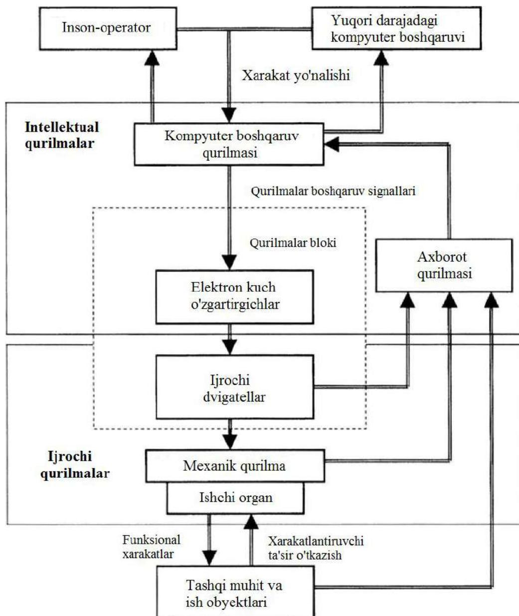
2.2-rasm. Mexanik mashinalarning umumiyl tuzilishi
