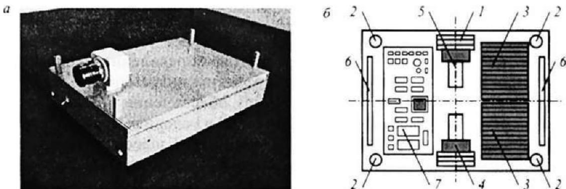
5.13-rasm. Transport mini robotining umumiyo ko‘rinishi va tartibi: 1 - ikkita mustaqil g‘ildirak; 2 - to‘rtta nazoratsiz to‘p qo‘llab-quvvatlaydi; 3-batareya paketlari; 4-ikkita Vites qutisi; 5 - ikkita DC vosita; 6-yansitici tarmoqli uchun optoelektron kuzatuv sensorlari; 7 - mikroprosessor robotni boshqarish tizimi (MPSU)
