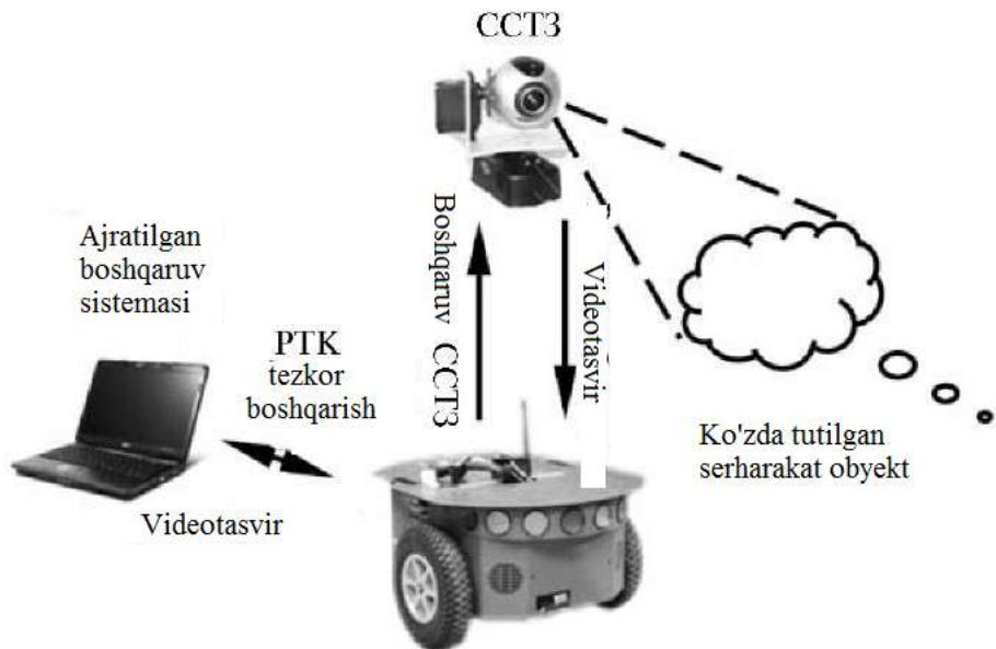
7.10-rasm. Mobil RTC Mobil robot umumiy tuzilishi
