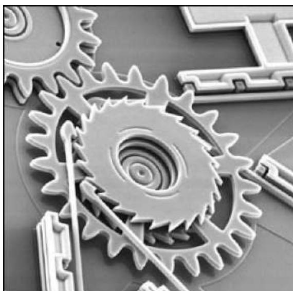
3.1-rasm. Horlama mikromexanizm
