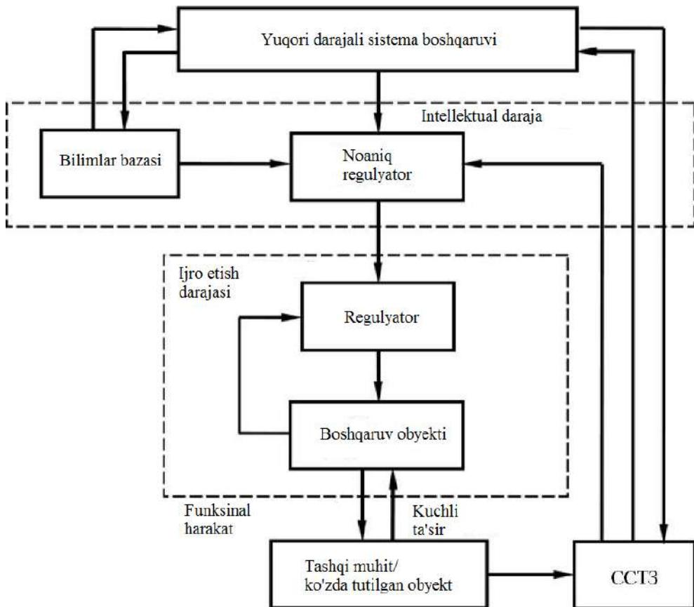
7.11-rasm. Loyqa mantiq va FTA usuli asosida robot tizimlarini boshqarish tiziminining umumiy tuzilishi
