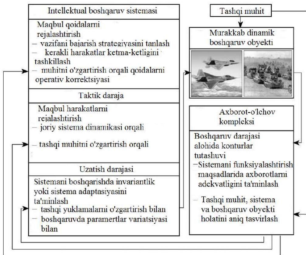
7.7-rasm. Murakkab dinamik obyektni aqlli nazorat qilish tizimining ierarxik tuzilishi.
