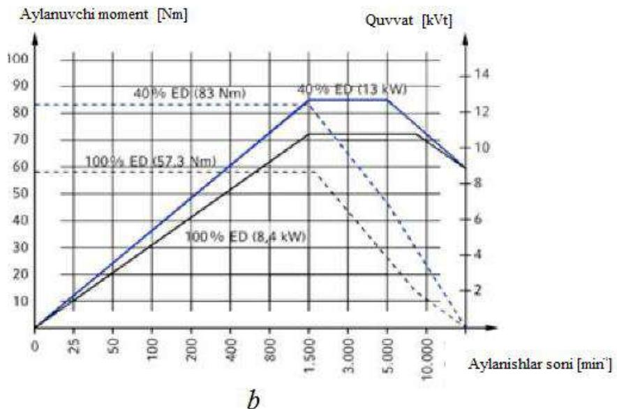
7.3-rasm. quvvat xususiyatlari grafikalari: a-standart shpindel; b-shpindel-motor
