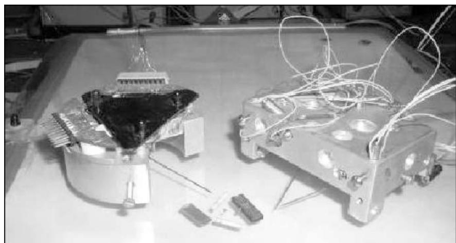
6.6-rasm. piezoelektrik mikroobotlar: "mikrob I" (o‘ngda) va "mikrob II" (chapda)
